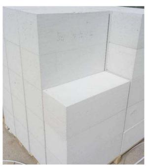
加气砖是一种轻质、多孔的新型建筑材料,具有质量轻、保温好、可加工和不燃烧等优点。以硅质材料(砂、粉煤灰及含硅尾矿等)和钙质材料(石灰、水泥)为主要原料,掺加发气剂(铝粉),通过配料、搅拌、浇注、预养、切割、蒸压、养护等工艺过程制成的轻质多孔硅酸盐制品。基本材料(1)粉煤灰:粉煤灰在加气混凝土中的作用主要是提供SiO2□同时,其中的Al2O3也具有较大作用(特别是在浇注以后的静停过程中)。(2)石灰:石灰是石灰石经高温煅烧,分解释放出CO2□但尚未达到烧结状态的白色块状物。(3)水泥:水泥是一种广使用的水硬性胶凝材料,品种很多,适用于加气混凝土的是硅酸盐水泥。(4)砂:砂是加气混凝土工业广采用的硅质材料,在加气混凝土中的作用主要是提供SiO2□安溪蒸压加气砖生产厂家空心砖,孔洞率等于或大于40%,孔的尺寸大而数量少的砖,常用于非承重部位,强度等级偏低。
